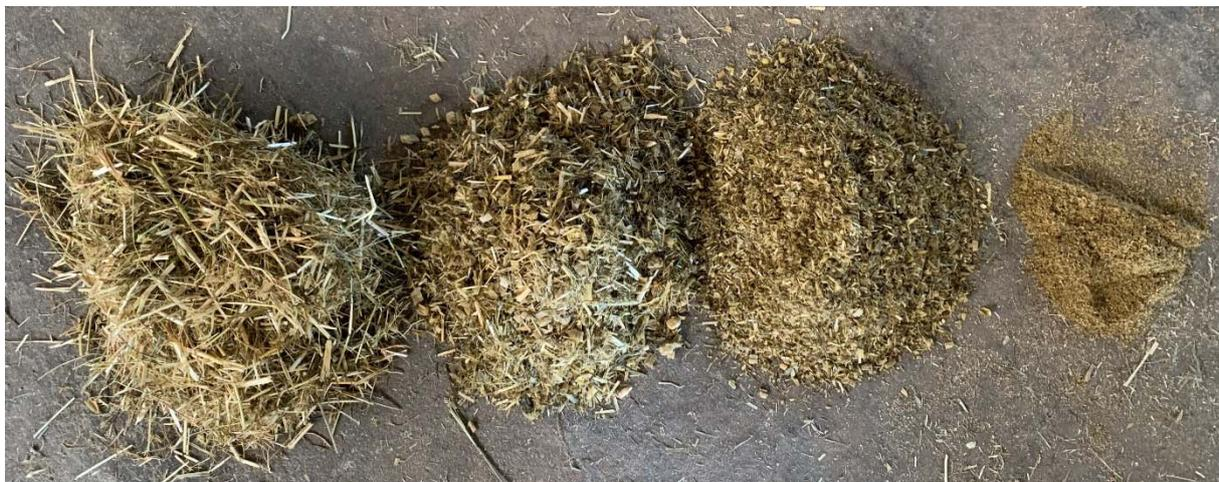
Abbildung 6: Rückstände aus den Sieben und dem Boden der Schüttelbox nach Schüttelprozess
