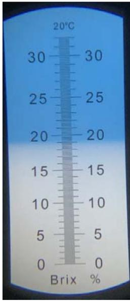
Abbildung 7: Brix-Skala optisches Refraktometer (Brix-Wert = 19)
